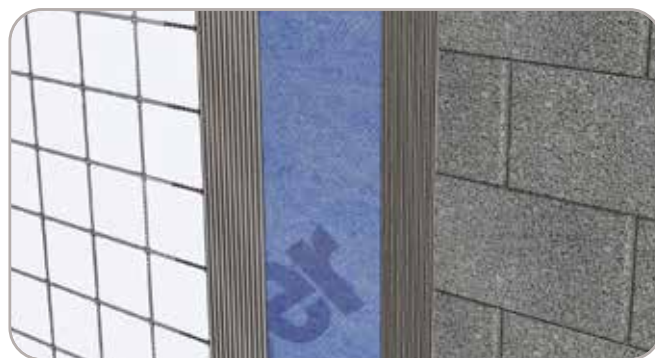
Figur 5.3: Tätskiktsapplikation på Leca Block.
