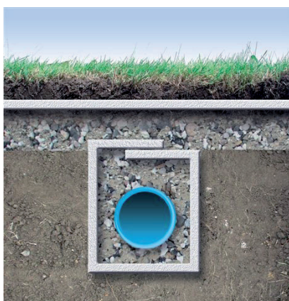
Markseparationer och dräneringssystem
