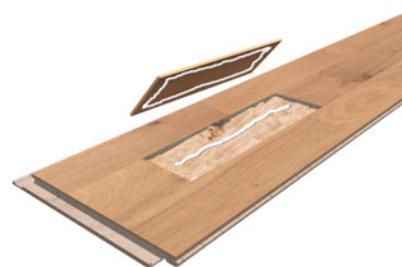
Välj och montera en ersättningsstav. Fyll hålet med polyesterspackel och tryck ned staven.
