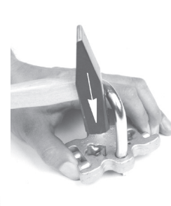
Tryck in hållbulten och slå in en ny spännhylsa
