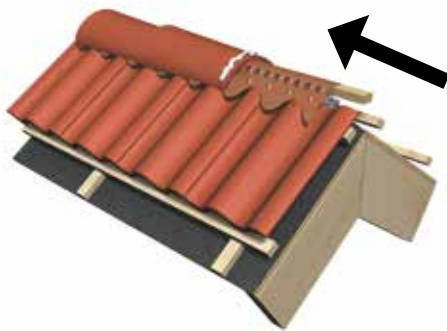
Bild 12. Ventilation av traditionellt papptäckt tak med slutna noken. Benders ventinock är spikad på nockbrädan och tätar mot inblåsande av regn och snö. Samtidigt medges luftcirkulation under takpannorna. Torra tak ruttnar inte! Nockpannorna läggs mot vindriktningen, se pil. Täta och skruva allt spika.
