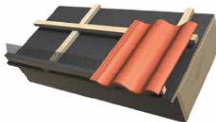
Bild 14. Fågelbandet monterats vid takfoten för att förhindra att fåglar bygger bo under takpannan. Det finns även ventilerat fågelband, används för tak med takfotskil.
