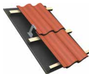
Bild 8. Clipset placeras så att både undre och övre panna läses med samma clips.
