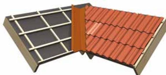
Bild 15. Utförande av rännedal Rännedalar är känsliga delar av takkonstruktionen och skall utföras omsorgsfullt. Pannorna skall kapas i raka linjer och spolans rena från damm omgäende.
