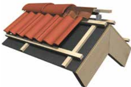
Bild 13. Benders nock och valmtättningsrulle är lätt att montera. Rulla ut en längd på nockplankan, spika eller häfta fast den. Ta sedan bort skyddstejpen på undersidan av rullen och tryck fast och forma mot takpannorna. Underlaget skall vara torrt och dammfritt och temperaturen bör vara minst +8°. Nock- och valmtättningsrullen finns i 300 mm bredd.
